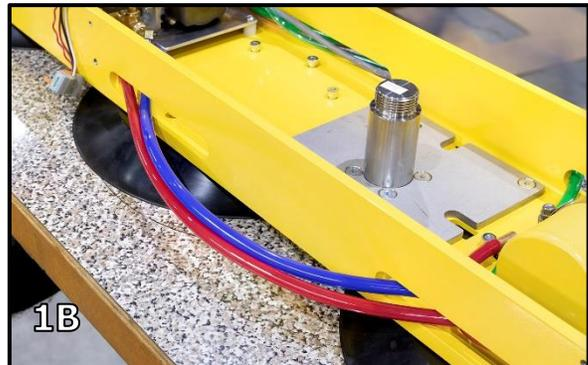
Der blaue Schlauch, der zum elektromagnetischen Ventil angeschlossen ist, verbindet sich mit beiden Kreisen mittels einem Y-förmigen Verbindungsstück (in Abbildung 1C eingekringelt).
