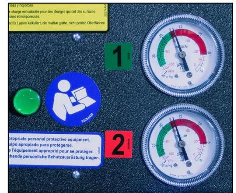
Wenn es mehr als 5 Sekunden dauert, bis ein Vakuumniveau von 5" Hg [-17 kPa] auf einem Vakuumanzeiger erreicht ist, drücken Sie auf jeden Saugerteller, der sich noch nicht angesaugt hat.
