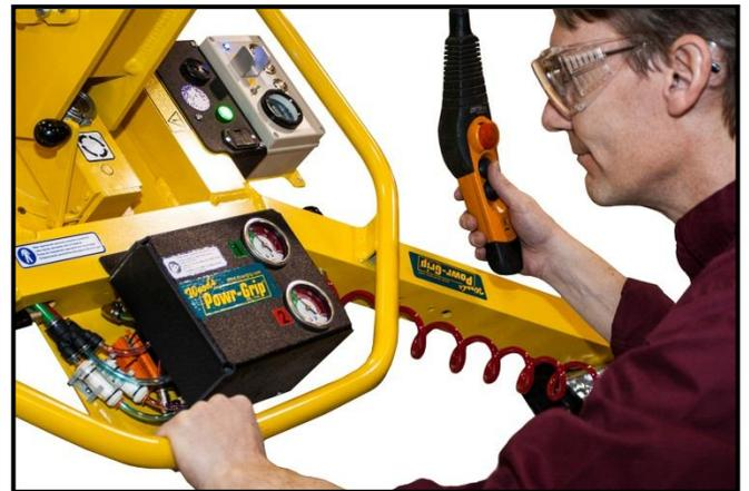
Immer wenn sich die Vakuumpumpe abschaltet, auch schaltet sich die Hebelampe *ab* und schaltet sich der Vakuumniedrigstand-Warnsummer *ein*, dem Bediener zu warnen. Falls dies passiert, während Sie eine Last heben, vergewissern Sie sich, dass beide Vakuumanzeiger ein Niveau von 18" Hg [-60 kPa] oder größer anzeigen. Falls eins von beiden dies erfühlt nicht:
