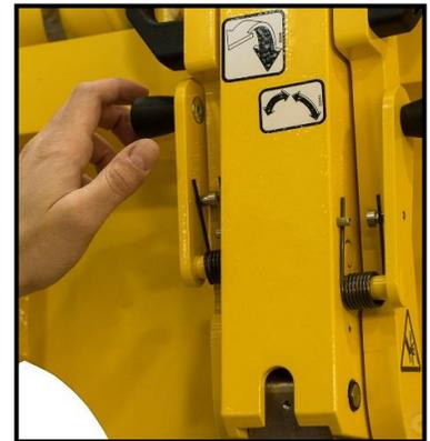
Eine Last mit Überhang kann Ihnen nötigen, den Kontrollhandgriff loszulassen, während die Last bei der horizontalen Position kommt. In diesem Fall, benutzen Sie Handsauger oder andere geeignete Mittel, die Kontrolle über die Last zu behalten.
