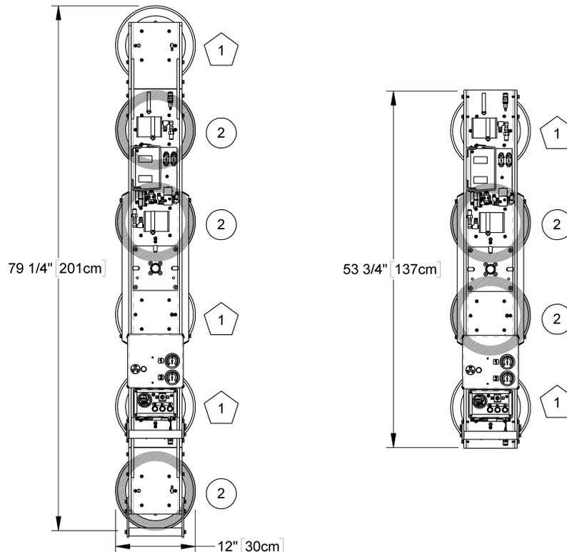
Abbildung des Saugerrahmens vom Hebegerät MRTALPCH611LDC (Standard-Modell)
