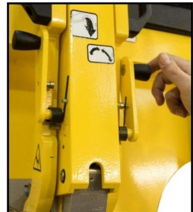
Anmerkung: Wenn kein Drehvorgang erforderlich ist, sollte der Drehschnappriegel immer eingerastet bleiben, um Lastschäden oder Körperverletzungen zu vermeiden.
