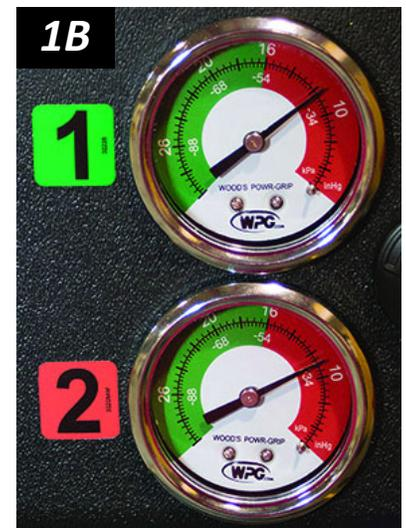
Si plus de 5 secondes passent avant que le niveau de vide atteigne -17 kPa (5 po Hg) sur l'un ou l'autre indicateur de vide, appuyez sur toute ventouse qui n'a pas encore obtenu une étanchéité. Dès que les ventouses ont obtenu une étanchéité, le palonnier devrait être capable de maintenir un vide suffisant pour soulever, sauf lors des emplois au-dessus de l'Altitude d'utilisation maximale.<sup>3</sup> S'il ne peut pas, effectuez « [Épreuve du vide](#) ».
