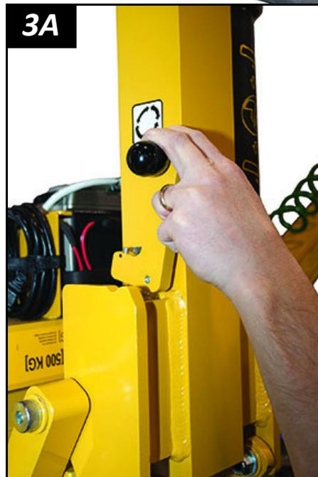
*Nota : si une rotation n'est pas nécessaire, le verrou de rotation doit demeurer engagé, pour éviter des endommagements de la charge ou des dommages corporels.*
