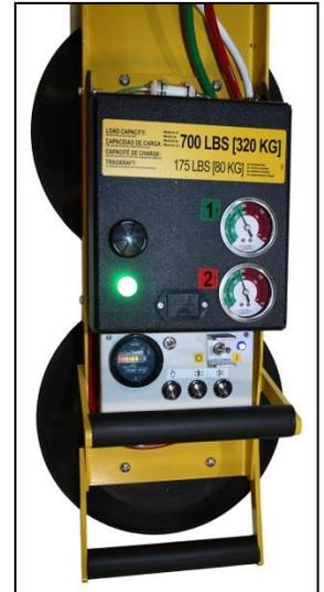
Si vous tentez de soulever la charge pendant que la sonnerie d'alarme continue ou avant que la lampe de levage soit allumée, il est possible qu'une telle tentative entraîne un dégagement de la charge et des blessures.
