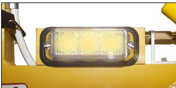
Nota : la lumière stroboscopique clignote tant que l'opérateur actionne les boutons d'autoriser ou de dégager. Cela montre à l'opérateur que la transmission des signaux à distance réussit et aussi avertit
