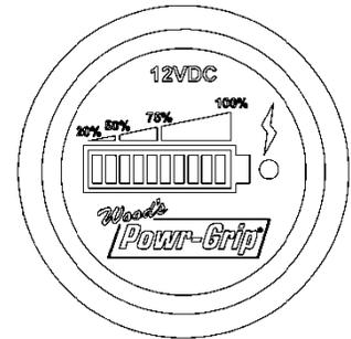
Lorsque l'interrupteur d'alimentation du palonnier est dans la position de allumer (⊕), l'indicateur de batterie montre le niveau d'énergie de la batterie automatiquement (à condition que le mode d'attente du palonnier n'est pas activé).<sup>22</sup>
