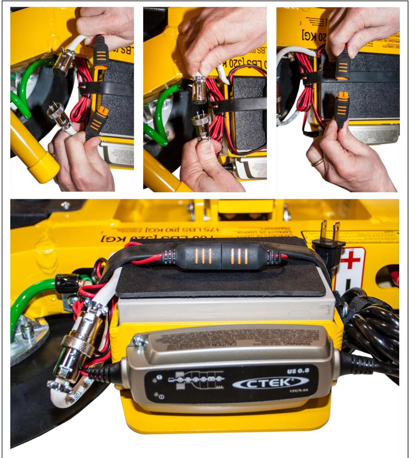
Installare la batteria del segnalatore di perdita di potenza in dotazione, come specificato in **MANUTENZIONE: PROVA DEL SEGALATORE ACUSTICO DI PERDITA DI POTENZA**.
