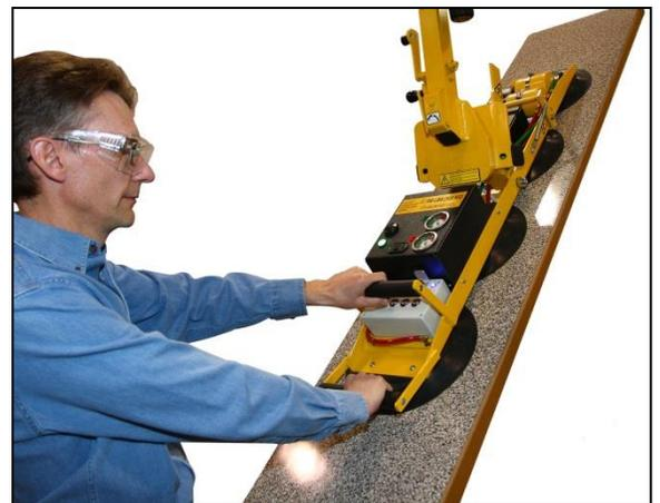
Tuttavia, se il grado di vuoto cala sensibilmente, la spia di sollevamento si *spegne* ed il segnalatore acustico di basso grado di vuoto si *attiva*, per avvertire l'operatore. Se ciò si verifica durante il sollevamento di un carico, allontanarsi e rimanere a distanza di sicurezza dal carico finché non sia possibile abbassarlo al suolo o su un sostegno stabile.
