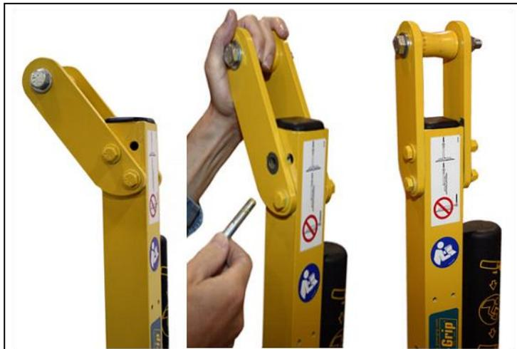
3) Sospendere il sollevatore a una gru come segue: scegliere un apparecchio di sollevamento (gru e argano, quando pertinente) di portata nominale pari al peso massimo del carico più il peso del sollevatore (vedi DATI TECNICI: Portata massima e Peso del sollevatore).
