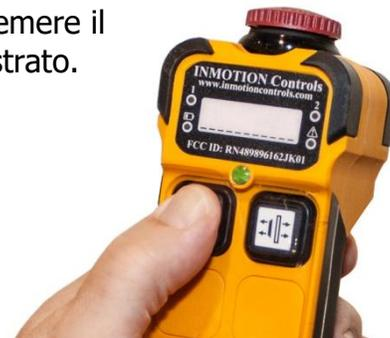
La pompa del vuoto inizia immediatamente ad aspirare aria attraverso le ventose ed il segnalatore acustico di basso grado di vuoto si attiva fino a quando il sollevatore non raggiunge un grado di vuoto idoneo al sollevamento del carico di peso massimo (vedi SOLLEVAMENTO E SPOSTAMENTO DEL CARICO: Interpretazione del segnalatore acustico e della spia di sollevamento, di seguito). L'applicazione di una pressione decisa sul sollevatore fa sì che le ventose inizino ad aderire al carico.<sup>13</sup>
