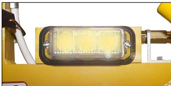
Nota: la luce stroboscopica lampeggia fino a quando l'operatore mantiene premuti i pulsanti di abilitazione o distacco. La luce indica all'operatore che la trasmissione dei
