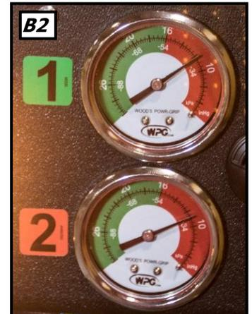
Se demorar mais de 5 segundos para que o nível de vácuo atinja 5" Hg [-17 kPa] em qualquer medidor de vácuo, pressione qualquer uma das ventosas que ainda não tenha fixado sobre a carga.
