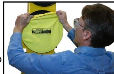
**!!-CE-!!** Para armazenar o Levantador em superfícies relativamente horizontais sem tombar, coloque as ventosas voltadas para baixo em uma superfície plana, lisa e limpa. Em seguida, abaixe a barra de elevação para a posição horizontal e coloque um suporte sob o ponto de elevação.
