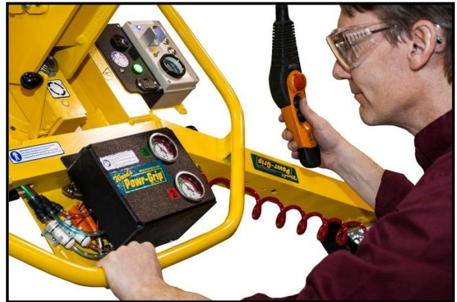
Se o nível de vácuo cair abaixo de 16 "Hg [-54 kPa] em qualquer medidor de vácuo, o alarme de advertência soará continuamente, a luz de levantamento se apagará e a tela de LCD exibirá um código de diagnóstico, junto com a mensagem "LOW VACUUM! Secure Load!" (VÁCUO BAIXO! Ancore a carga!). Se isto ocorrer enquanto você estiver levantando uma carga, afaste-se imediatamente e mantenha-se afastado da carga até que ela possa ser baixada com segurança até o solo ou um suporte estável.
