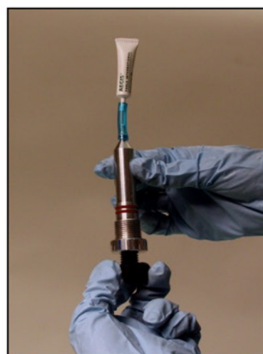
アダプターを通して接着剤を注入 チャンバーに入れる
