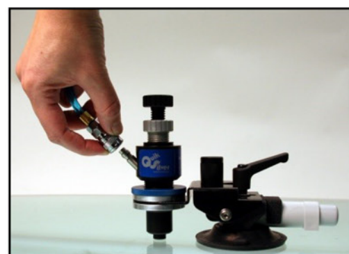
ホースアッセンブリーを補修用台座に取り付ける
