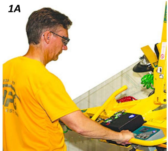
**Si la bomba de vacío no puede vencer una fuga**, el zumbador de aviso suena continuamente, la luz de levantamiento se apaga y la pantalla de cristal líquido muestra '¡VACÍO INSUFICIENTE!',
