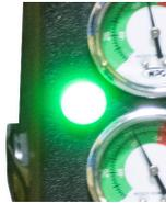
**Nunca levante la carga a menos que la luz de levantamiento esté iluminada, porque un levantamiento precipitado podría ocasionar el desprendimiento de la carga y las lesiones personales.**
