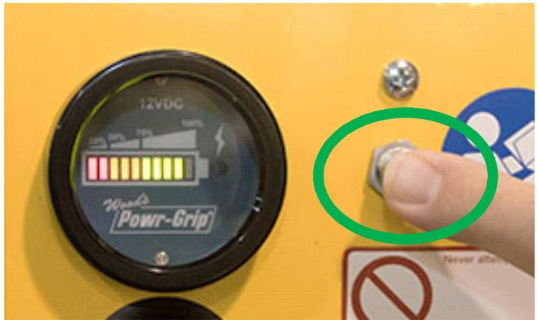
1..... Si la bomba marcha o el cargador de batería está conectado a una fuente de alimentación CA, el indicador mostrará un nivel incorrecto de la energía.
