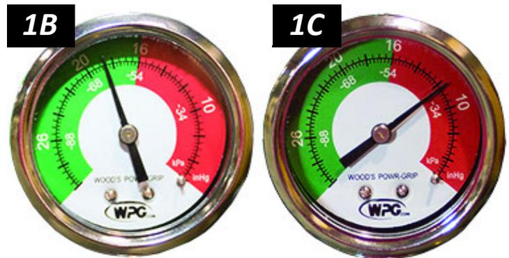
Si se requieren más de 5 segundos para obtener un nivel de vacío de -17 kPa (5" Hg), oprima cada ventosa que aún no se haya sellado.
