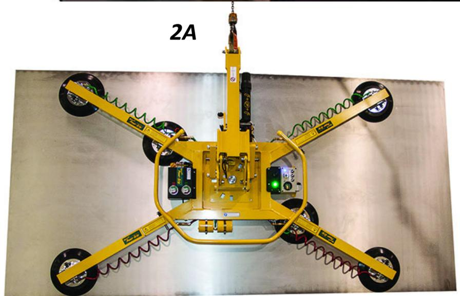
1..... El levantador está diseñado para manejar el máximo peso de la carga cuando el centro de gravedad de la carga está colocado hasta 5 cm (2") del eje de rotación del levantador. Las cargas descentradas pueden girar o inclinarse inesperadamente (según el caso).
