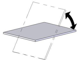
*Nota: el pestillo engancha automáticamente cuando el marco de ventosas inclina a la posición vertical.*
