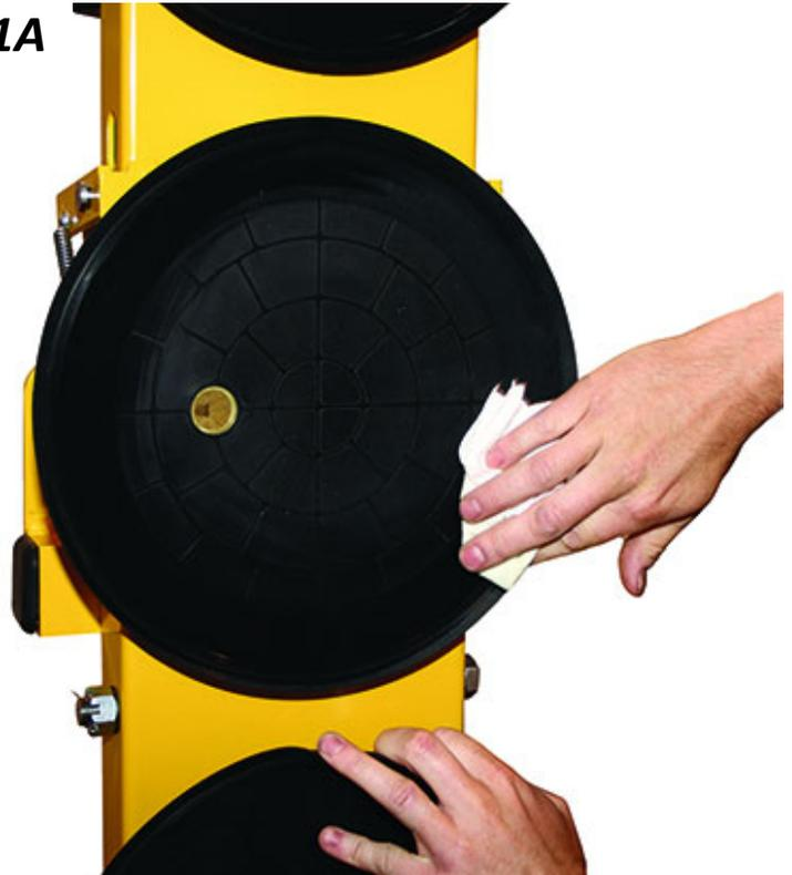
1..... Se puede utilizar un cepillo con las cerdas *que no dañen la goma* para separar los contaminantes que se pegan en los bordes selladores. Si estos métodos de limpiar no tienen éxito, contacte a WPG o a un distribuidor autorizado para obtener asistencia.
