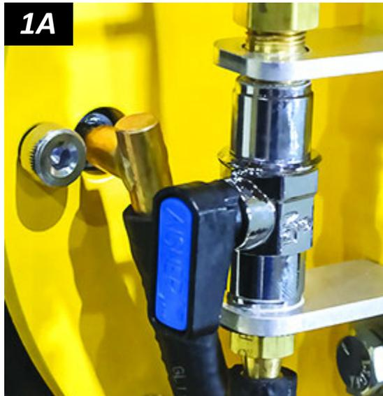
Para desactivar una ventosa, cierre la válvula (es decir, ponga la palanca en la posición *perpendicular* con la línea de vacío — figura 1B).
