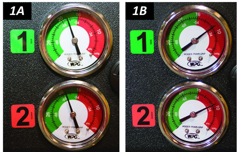
Si se requieren más de 5 segundos para obtener un nivel de vacío de -17 kPa (5" Hg) en cualquiera de los vacuómetros, oprima cada ventosa que aún no se haya sellado. Una vez que las ventosas se han sellado, el levantador normalmente puede mantener el vacío suficiente para levantar, a menos que se use encima de la máxima Elevación de funcionamiento.<sup>3</sup> Si no lo puede, lleve a cabo la 'Prueba de vacío'.
