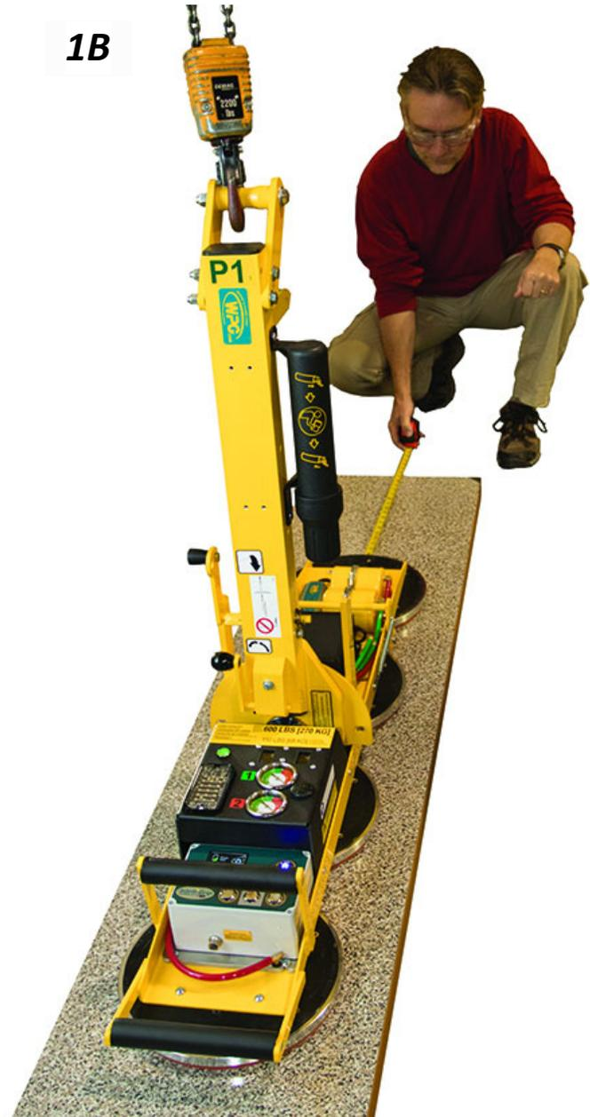
1..... El levantador está diseñado para manejar el máximo peso de la carga cuando el centro de gravedad de la carga está colocado hasta 5 cm (2") del eje de rotación del levantador. Las cargas descentradas pueden girar o inclinarse inesperadamente.
