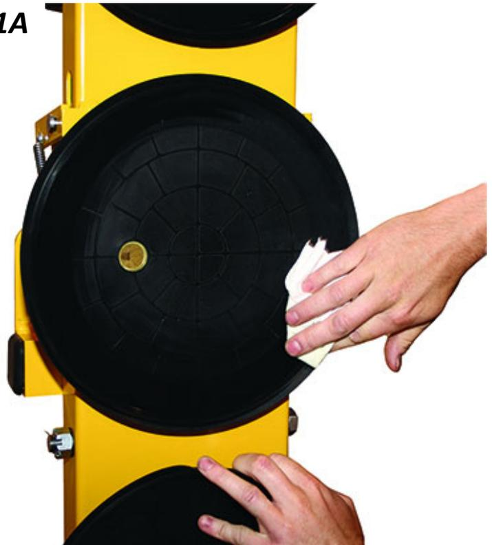
1..... Se puede utilizar un cepillo con las cerdas *que no dañen la goma* para separar los contaminantes que se peguen en los bordes selladores. Si estos métodos de limpiar no tienen éxito, contacte a WPG o a un distribuidor autorizado para obtener asistencia.
