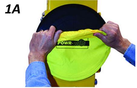
**CE/UKCA** – Para evitar que el levantador vuelque en las superficies casi horizontales, ponga las caras de las ventosas hacia abajo en una superficie limpia, lisa y plana. Después baje el colgador de levantamiento y ponga un soporte debajo del punto de levantamiento.
