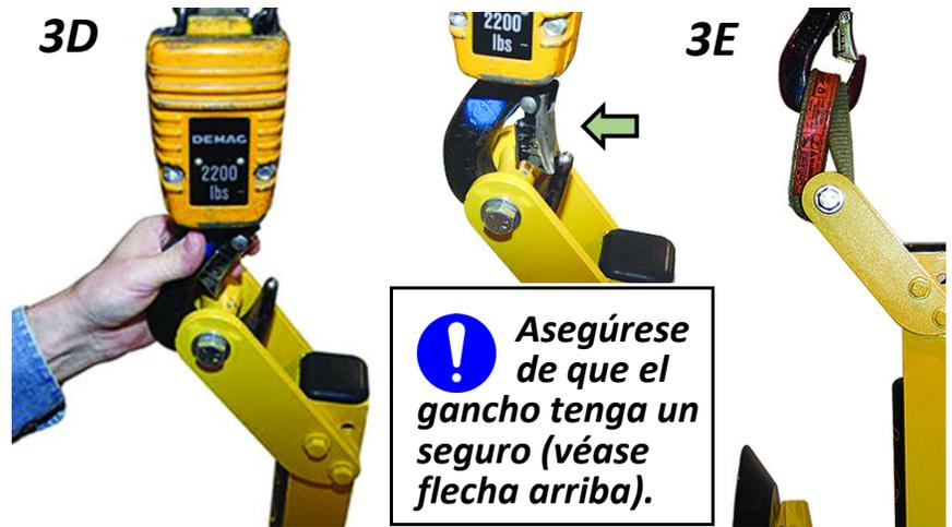
*Nota: utilice un aparejo de alzamiento (figura 3E) según lo necesario para asegurarse de que el gancho no interfiera con la carga.*
