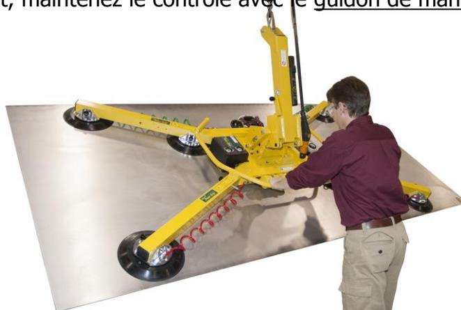
en est ainsi, garder le contrôle de la charge en utilisant les ventouses à main ou autres moyens appropriés d'après l'illustration.
