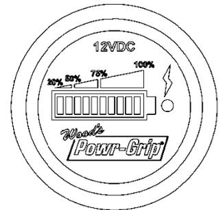
Lorsque l'interrupteur d'alimentation du palonnier est dans la position de allumer (⊕), l'indicateur de batterie montre le niveau d'énergie de la batterie automatiquement (à condition que le mode d'attente du palonnier n'est pas activé).<sup>25</sup>
