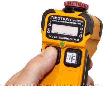
La pompe à vide commencera à provoquer une suction immédiate aux ventouses et l'avertisseur sonore de vide insuffisant produira une sonnerie d'alarme jusqu'à ce que le palonnier atteigne le vide suffisant pour soulever le poids maximal de la charge (voir POUR SOULEVER ET DÉPLACER LA CHARGE : Interpréter l'avertisseur sonore et la lampe de levage ci-après). La pression ferme au palonnier aide que les ventouses commencent à obtenir une étanchéité avec la charge.<sup>16</sup>
