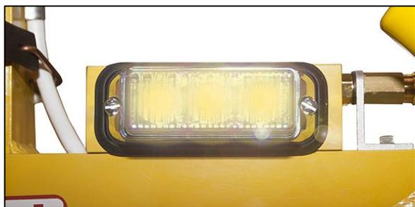
Nota : la lumière stroboscopique clignote tant que l'opérateur actionne les boutons d'autoriser ou de dégager. Cela montre à l'opérateur que la transmission des signaux à distance
