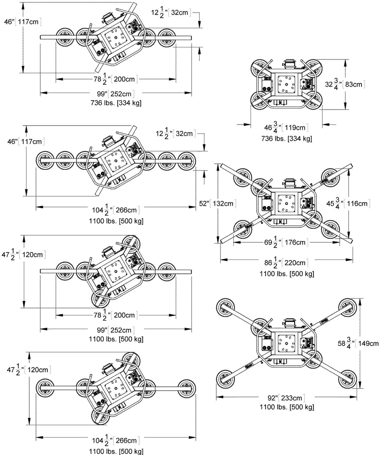
Schéma du châssis des ventouses du modèle standard MRTA611LDC2. Voyez les CARACTÉRISTIQUES TECHNIQUES pour trouver les Capacités de charge maximales des autres modèles.
