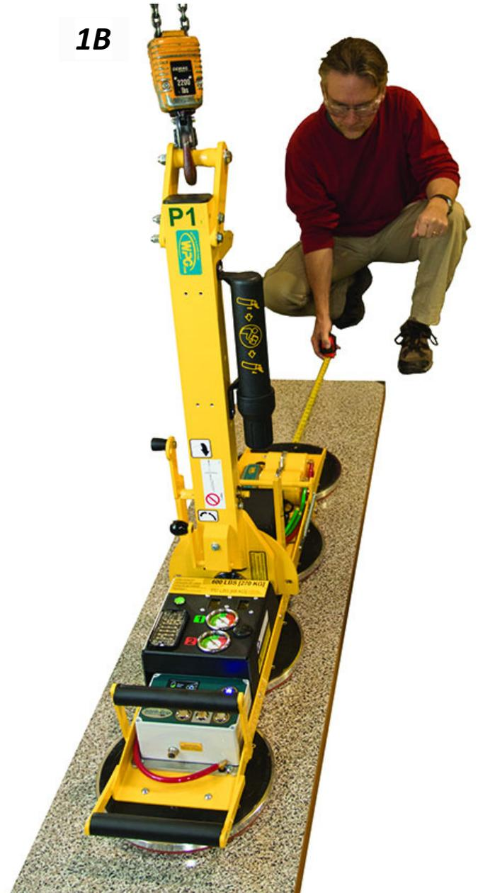
1..... Le palonnier est construit pour manier le poids maximal de la charge quand le centre de gravité est situé jusqu'à 5 cm (2 po) de l'axe de rotation du palonnier. Des charges mal centrées peuvent tourner ou basculer de façon inattendue.
