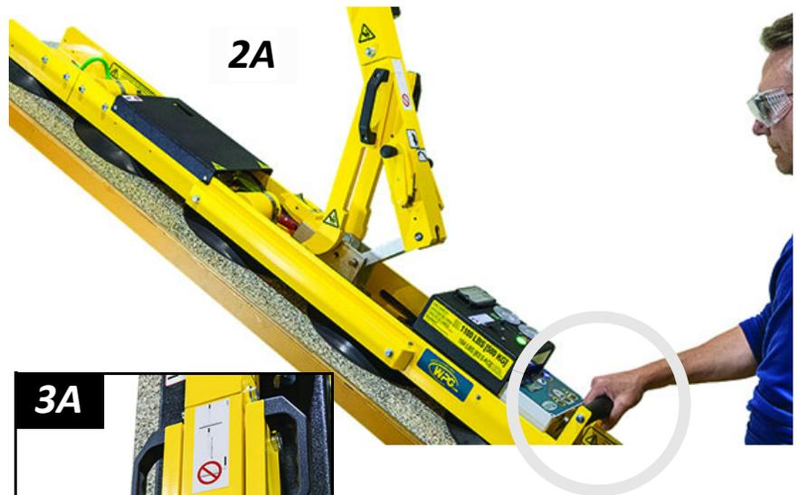
3) Si le châssis des ventouses est verrouillé, tirez le levier de déverrouillage du basculement (fig. 3A) pour dégager le verrou de basculement.
