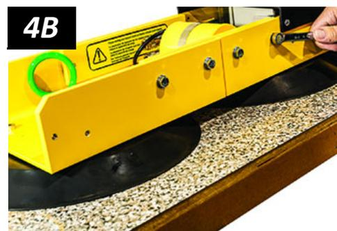
3) Alignez les trous des boulons dans la rallonge du châssis des ventouses avec ceux dans le châssis des ventouses.
