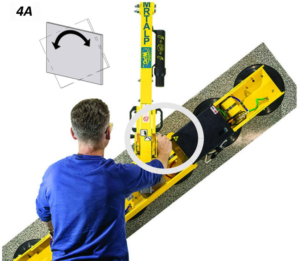
*Nota : pendant que la rotation n'est pas nécessaire, le verrou de rotation doit demeurer verrouillé, pour éviter des dommages de la charge ou corporels.*
