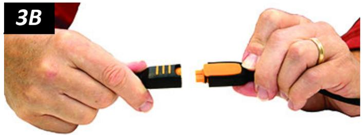
3) Déconnectez les connecteurs électriques (figs. 3A-B et 3C-E) afin d'éviter la décharge de la batterie.
