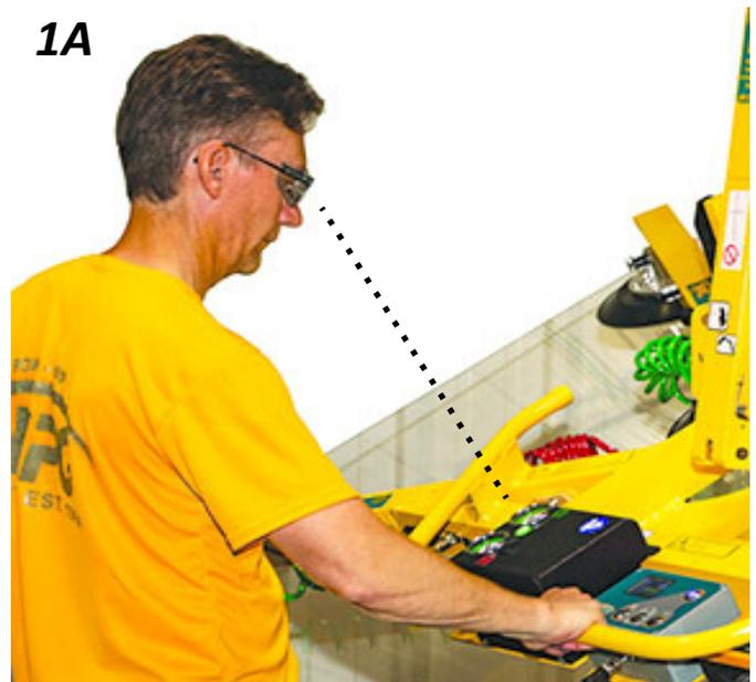
1..... La détection automatique des fuites ne remplace **pas** « [Épreuve du vide](#) », qui est exigée par le « [PLAN DES INSPECTIONS](#) » et les « [ÉPREUVES](#) ». On peut régler la sensibilité de la détection des fuites (voir « [INTELLI-GRIP® OPERATOR MENUS](#) » (MENUS OPÉRATEUR D'INTELLI-GRIP®) dans « [SERVICE MANUAL](#) » (MANUEL DE L'ENTRETIEN)).
