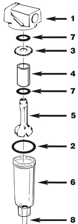
**⚠ AVERTISSEMENT :** quand le filtre à air est utilisé dans un système de *vide*, au lieu de la pression, **il ne faut pas** utiliser la purge à tourner (8) pour extraire le liquide de la cloche. **Ne** déplacez **jamais** la purge à tourner, parce que il est possible que les impuretés logent dans le joint de la purge et occasionne une fuite d'air.
