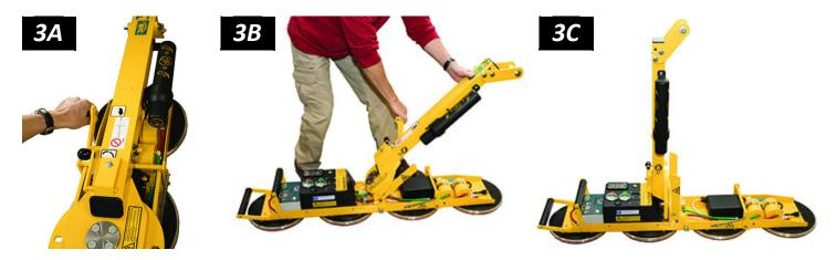
3.2) Dégager le verrou de basculement et élevez la barre de levage (fig. 3A-C).
