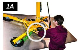
Ne permettez jamais le mouvement d'aucune soupape d'arrêt de ventouse à la position ouverte ou fermée lors du levage, parce ceci pourrait entraîner un dégagement de la charge et des dommages corporels.
