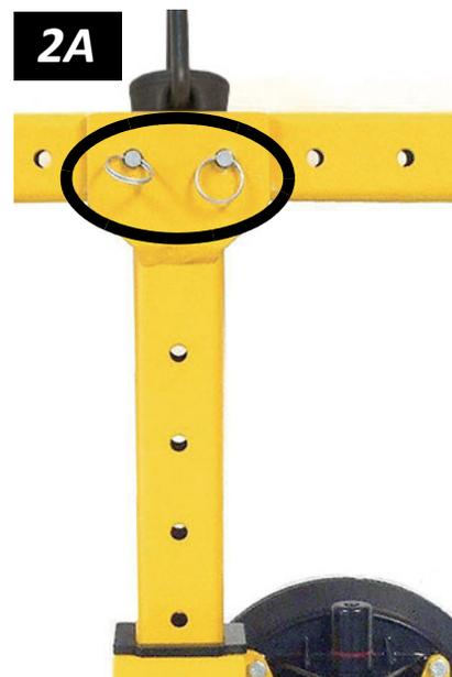
1..... Pour supporter les dimensions maximales de la charge, il faut installer le bras central sur le palonnier.
