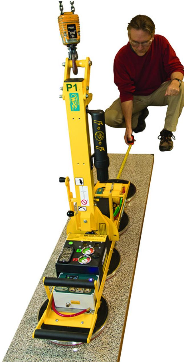
1.... このリフターは、積載物の重心がリフターの回転軸の 2" [5 cm] 以内に配置されている場合に、最大積載重量を扱えるよう設計されています。中央に配置されていない積載物は、不意に回転したり、傾いたりすることがあります。
