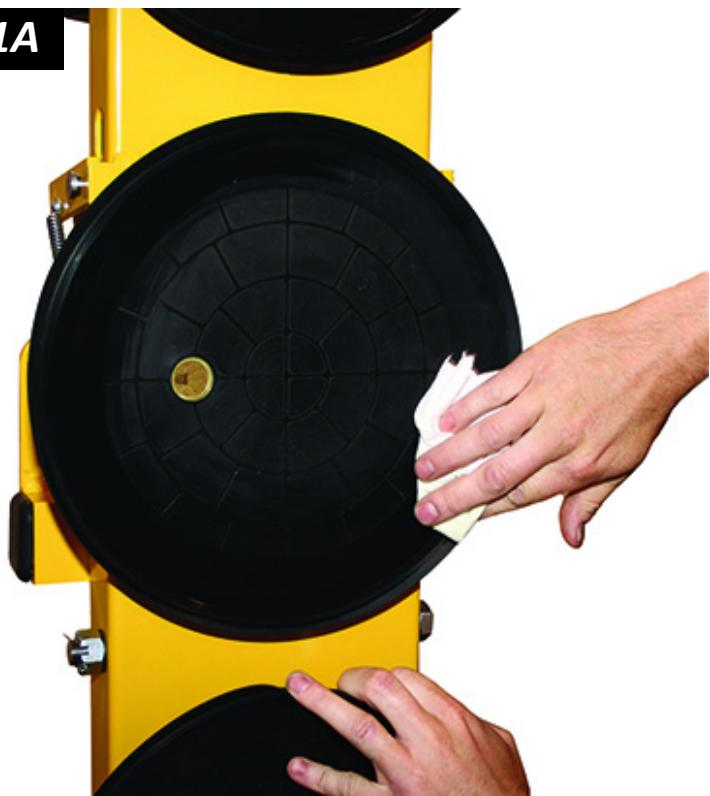
1.....密閉エッジに付着した汚れは、ラバーを痛めることがないブラシを使用して落とします。この方法で汚れが落ちない場合には、WPG 社または正規ディーラーまでご連絡頂き、指示を仰いでください。
