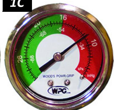
真空度が $5$ " Hg [-17 kPa]に到達するまで5秒以上かかっている場合、密閉が完了していないバキュームパッドを押さえるようにします。
