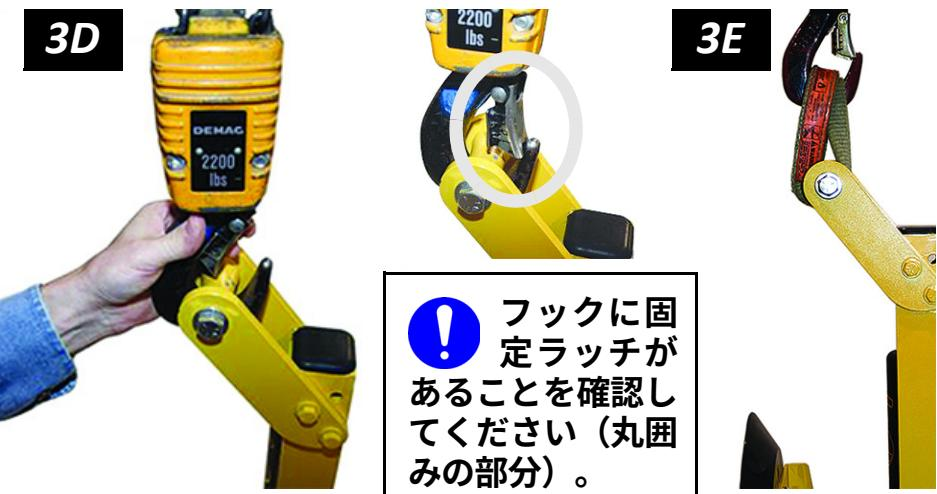
必ず、最大積載量とリフター重量の合計に対応するリギングを使用してください。
