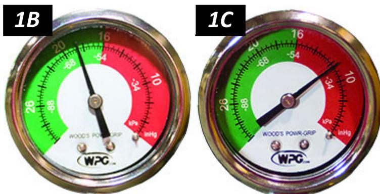
Se demorar mais de 5 segundos para que o nível de vácuo atinja 5" Hg [-17 kPa], pressione qualquer uma das ventosas que ainda não tenha fixado.
