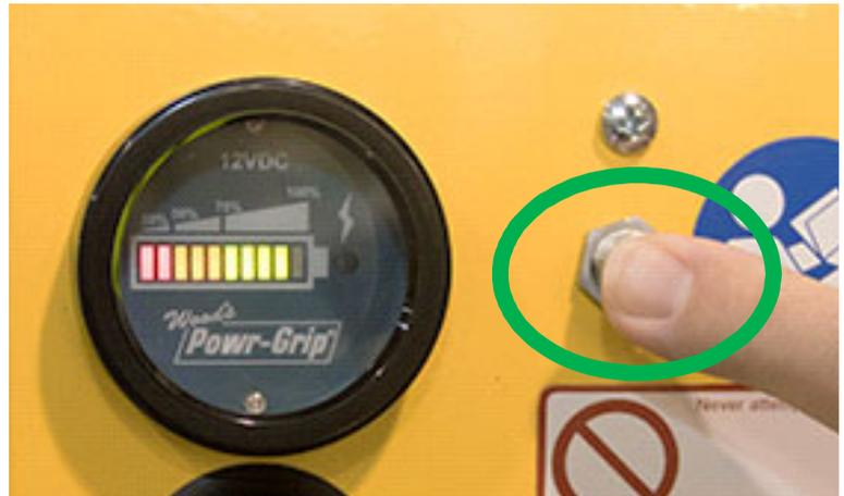
1..... Se a bomba estiver funcionando ou o carregador de baterias estiver conectado a uma fonte de alimentação (AC), a leitura de carga no medidor da bateria não seria precisa.
