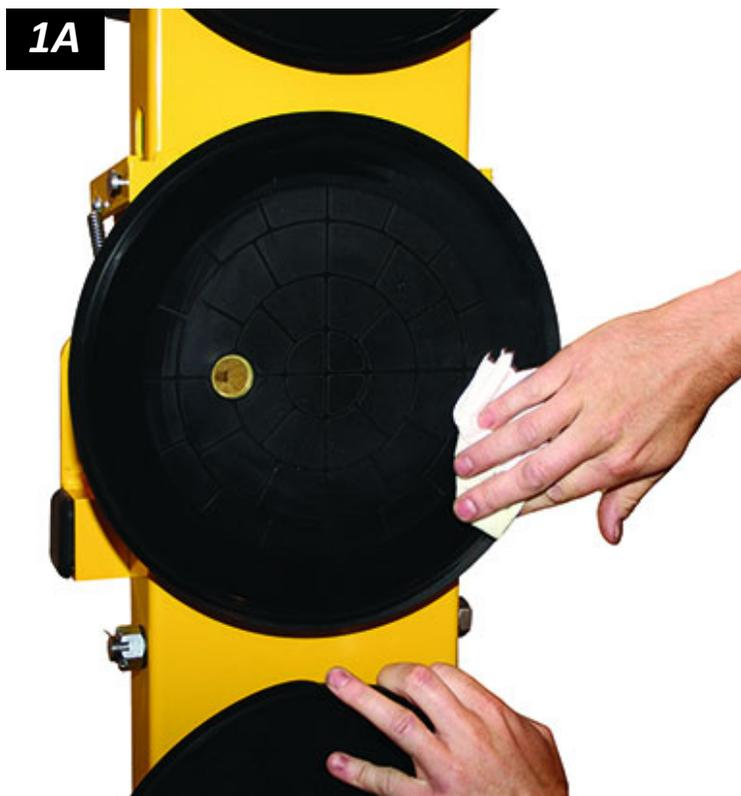
1..... Uma escova com cerdas *que não prejudicam a borracha* pode ser usada para remover contaminantes que se apegam às bordas de vedação. Se esses métodos de limpeza não forem bem-sucedidos, entre em contato com WPG ou com um Distribuidor Autorizado para obter assistência.
