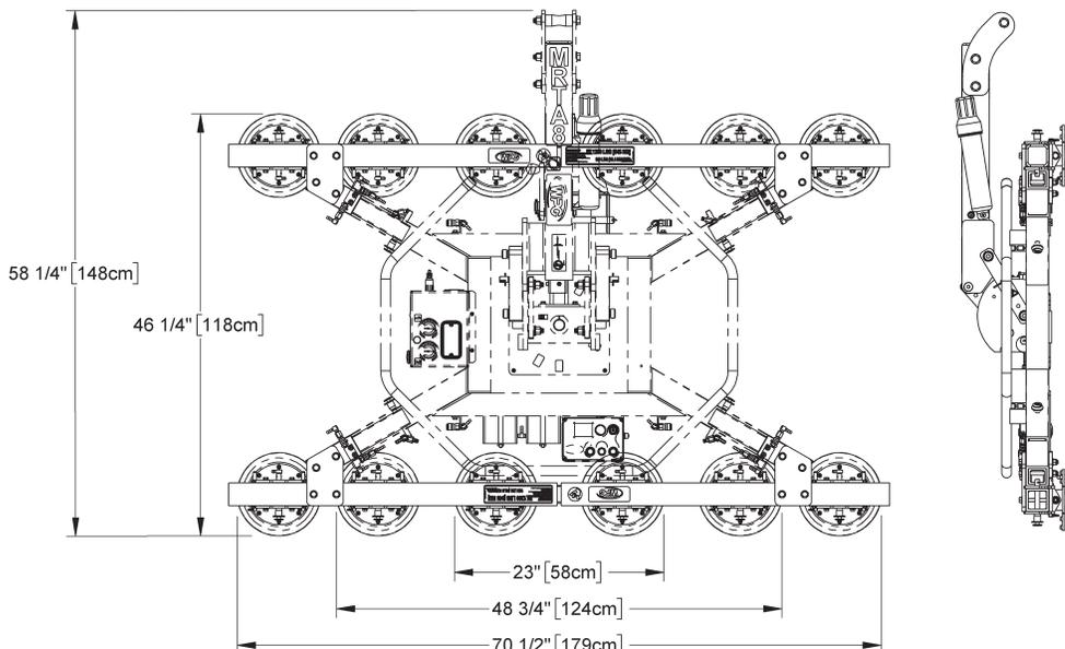
Das Vakuum-Hebegerät MRTA811LDC3 ist hier mit dem Saugerrahmen-Adapter für gebogenes Glas abgebildet.
