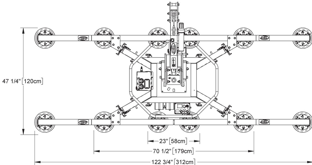
Das Vakuum-Hebegerät MRTA811LDC3 ist hier mit Verlängerungsarmen und dem Saugerrahmen-Adapter für gebogenes Glas abgebildet.
