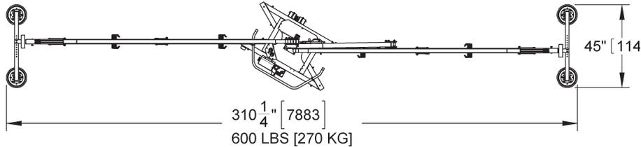
Se adapta a los paneles más de 60 ft [18,5 m] de largo con los siguientes dispositivos optativos: 97463, 97464 and 97465HV (nota: esta configuración requiere un segundo par de brazos en forma 'T')
