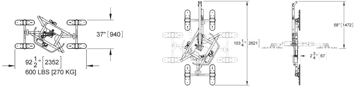
Se adapta a los paneles más de 55 ft [17 m] de largo con el dispositivo optativo 97464
